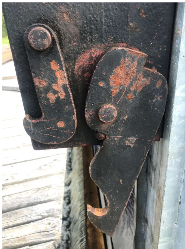
Bild 6. Lyftblocket med "låsbrickan" i läge för upptagning av sätt.
